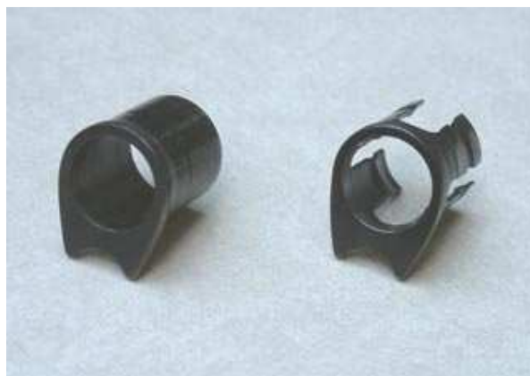
A sinistra un bushing di tipo standard. A destra un "collet bushing", la boccia elastica introdotta a partire dalla serie '70.
