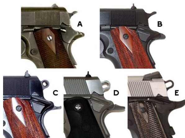
Differenti profili di sicure dorsali della 1911. In alto a sinistra abbiamo la sicura dorsale della 1911 prigenia (A), a destra quella della 1911-A1 (B). In basso le sicure dorsali più moderne; a partire sinistra, la “Ducktail” (C), la “Duckbill” (D) e la “Beavertail” (E), quella che in assoluto consente una presa più alta.
