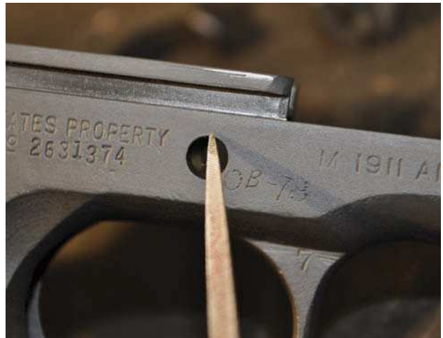
Controllare eventuali rotture sopra il foro del perno dello slide-stop.
