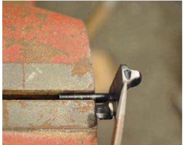
Se la sicura manuale è lasca, è possibile aumentare la fossetta di arresto con uno strumento Freedom (2) e un utensile arrotondato.
