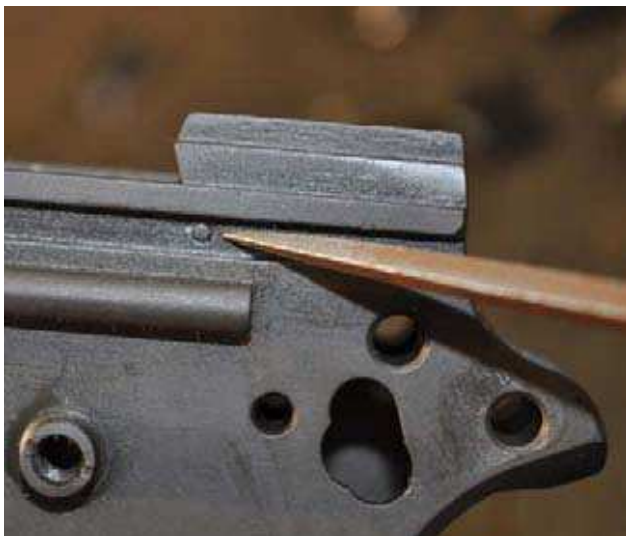
Una spina dell'estrattore di tipo pieno.
