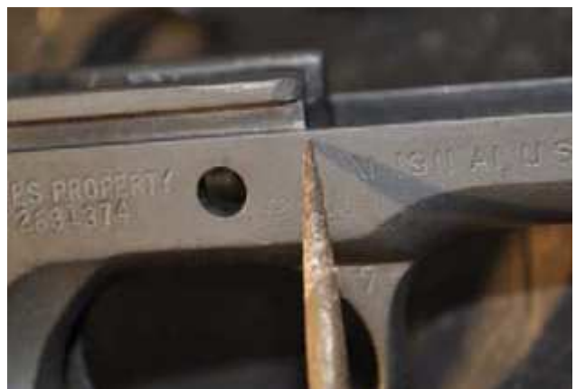
Ricercare anche eventuali rotture nella parte anteriore del fusto a livello della giunzione delle guide di scorrimento.
