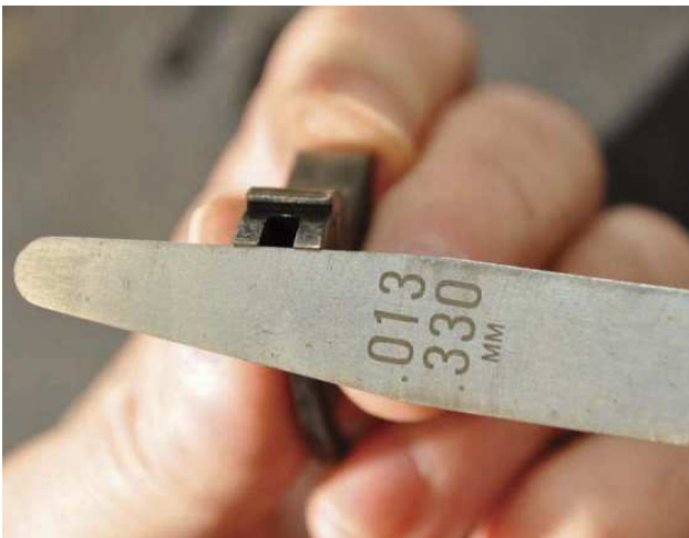
Questa foto mostra come i denti del cane siano al di sopra dello spessimetro da 0.013 pollici.
