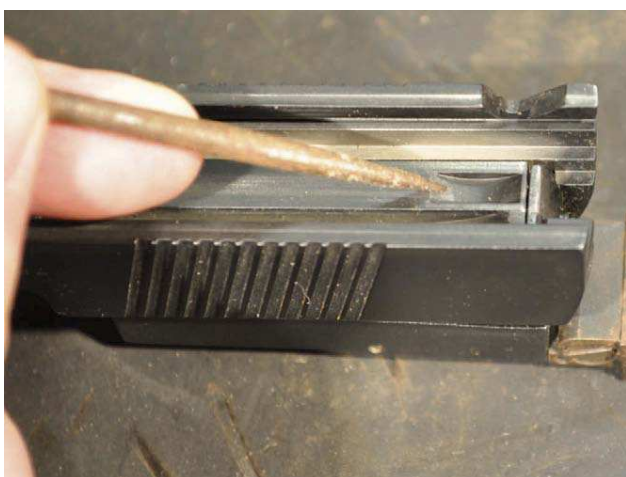
Ispezionare la fresatura di azionamento del disconnettore per cercare dei danni.
