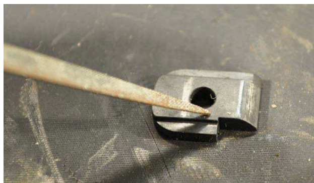
La piastrina di blocco del percussore è incline a rompersi dove l'angolo acuto si avvicina al foro.
