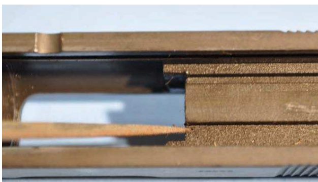
Questa zona presso il foro dell'estrattore è abbastanza sottile ed è incline alle rotture.
