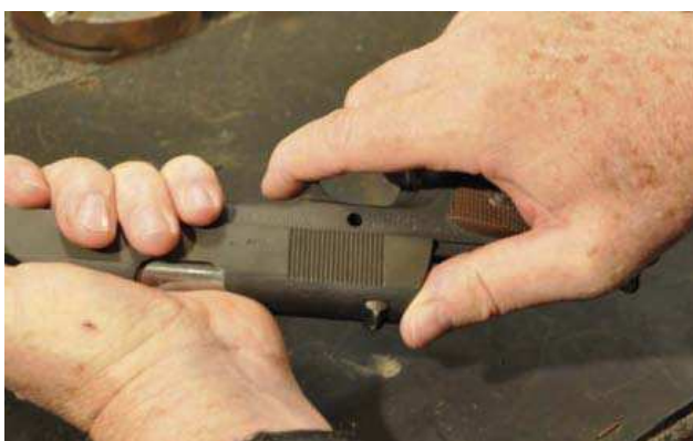
Accompagnare il carrello fuori dal fusto, intrappolando la molla di recupero con la mano sinistra. Ricordate, la molla è sotto forte pressione.
