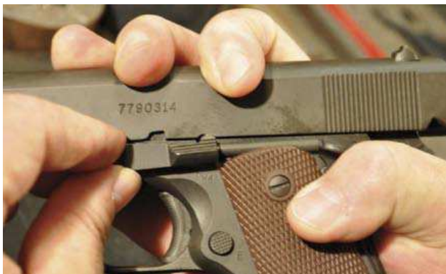
Arretrare il carrello fino alla tacca della leva di blocco carrello e spingere fuori la leva dal lato destro della pistola.
