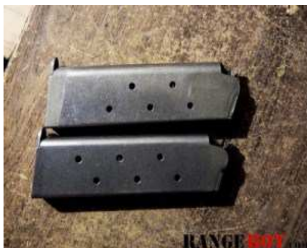
Sopra, il caricatore da 7 colpi con l'elevatore con il bottone, sotto, il caricatore da 8 colpi con l'elevatore piatto.
